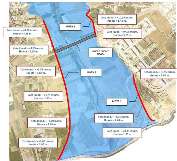
Figura 8: Llanura de inundación ( T=500 ) prevista tras la ejecución de las motas.
