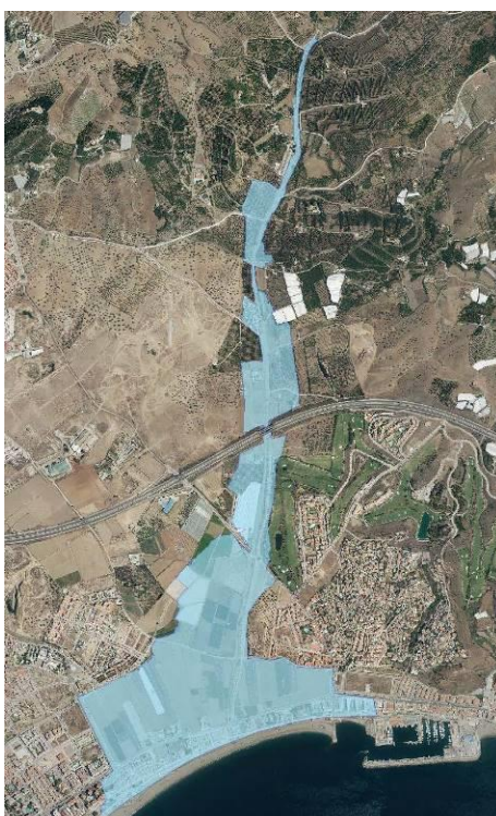
Figura 55: Llanura de inundación del río Seco para T=500 años.
