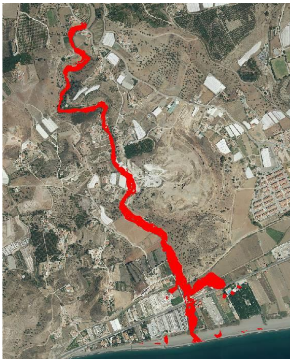
Figura 60: Zona con graves daños en caso de inundación para T=500.
