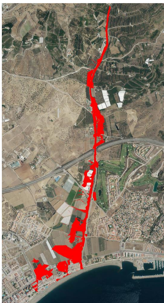
Figura 57: Zona con graves daños en caso de inundación para T=500 .
