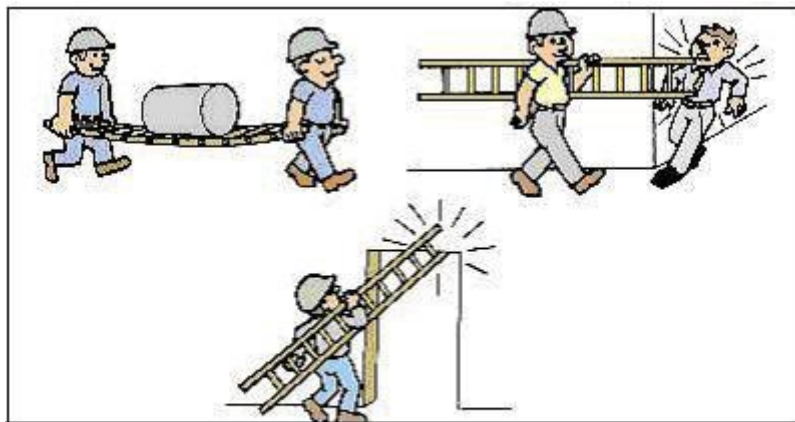
Fig. 1 Formas incorrectas de transportar la escalera
