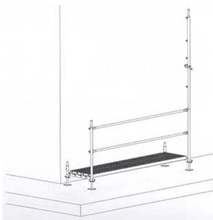
Instalar el segundo marco en forma de L y accionar el sistema de unión entre ambos para formar un marco completo, o en su caso instalación de la segunda hilera de marcos.
