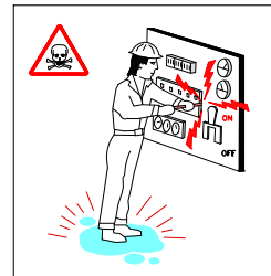
REPARACION DE EQUIPOS BAJO TENSION
