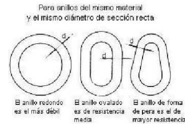
Fig. 5: Influencia de la forma de los anillos en su resistencia
