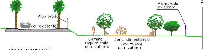
SECCION TIPO C-C' E 1/300
