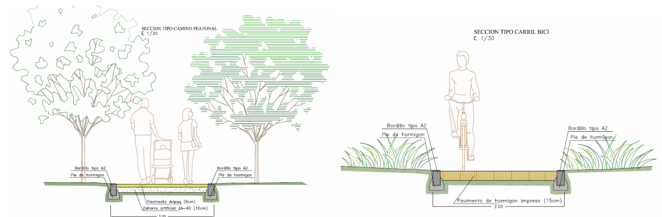
Sección tipo camino peatonal y carril bici.
