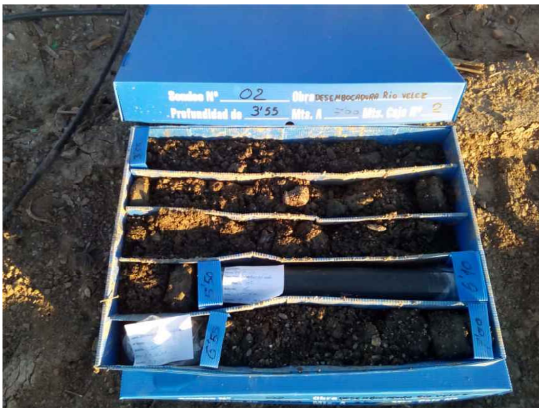
Foto de testigo de sondeo. Sondeo 2, Caja 2.
