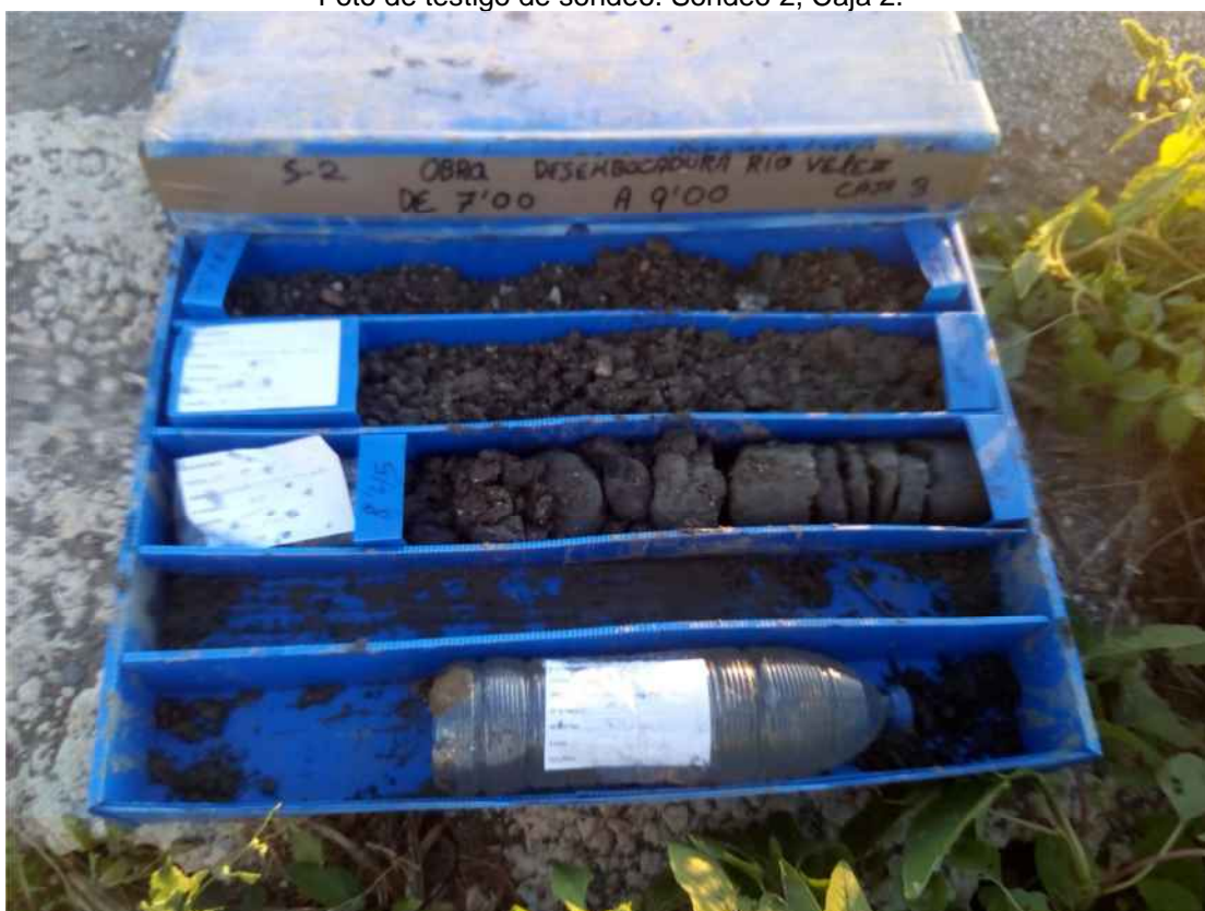
Foto de testigo de sondeo. Sondeo 2, Caja 3.
