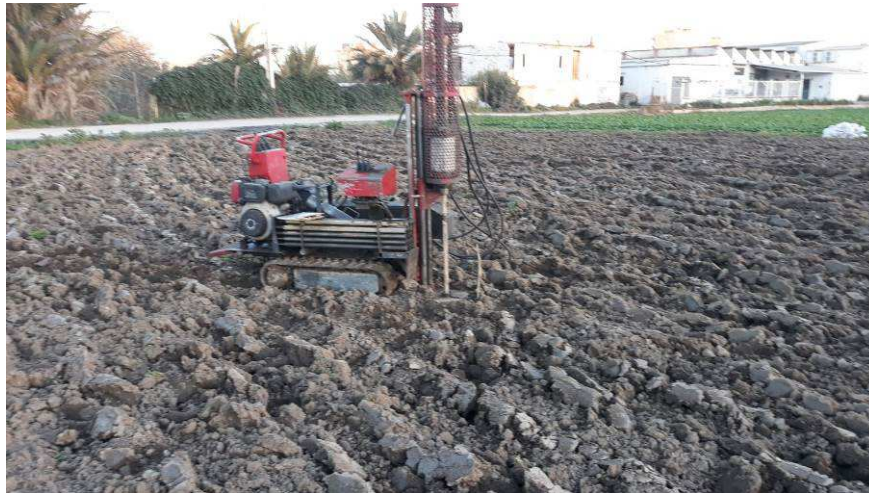
Figura Nº 16.- Emplazamiento del ensayos a penetración dinámica P-04 NORTE.
