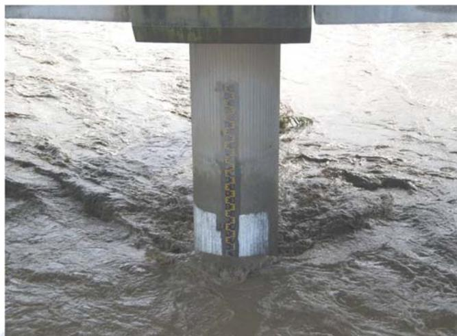
Analizando hidráulicamente esta sección del cauce, se desprende que para esta altura de lámina de agua, el caudal de paso ronda los 280 m<sup>3</sup>/s. Insistimos que en dicha fecha no se produjo desbordamiento.
